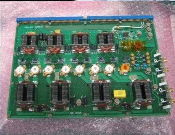
月レーダサウンダー送信部の基板
